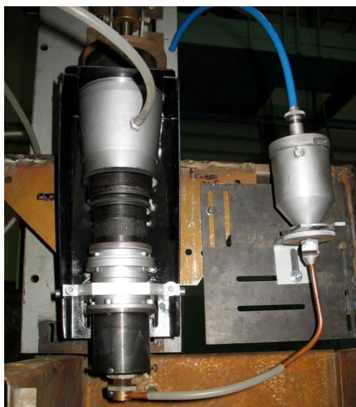
Рис. 1. Розроблена головка для лазерного легування з дозатором порошкової суміші
